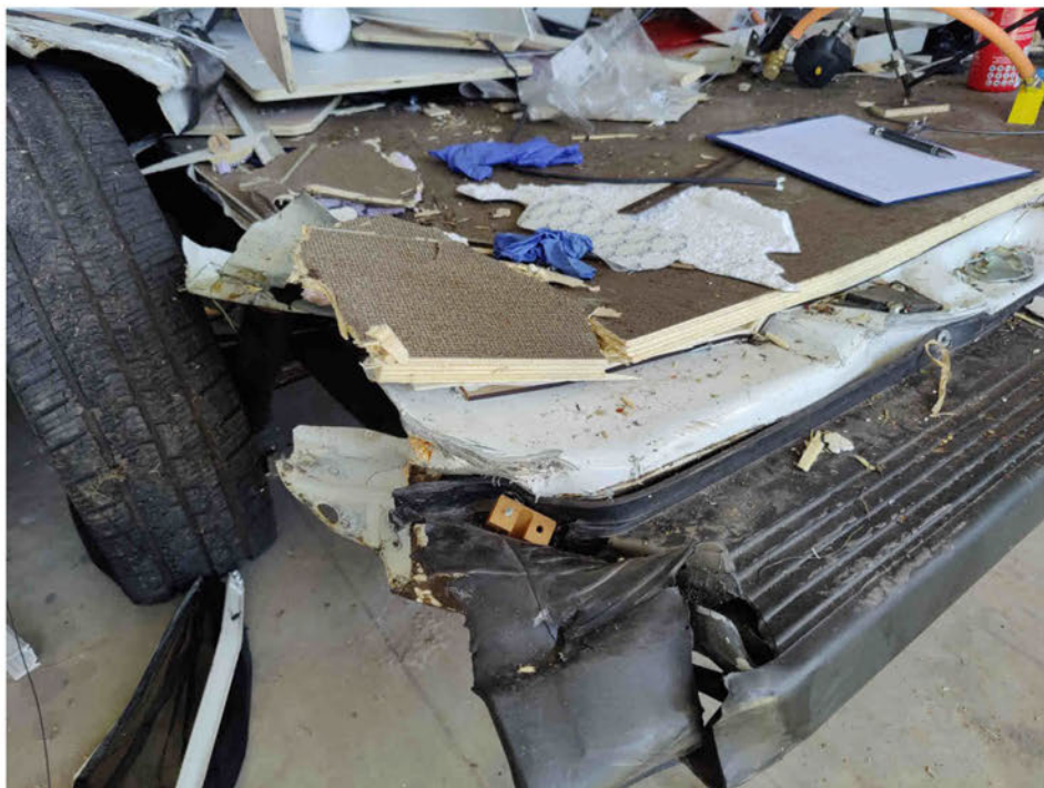
Bild 9 Bodenplatte hinten links gebrochen
