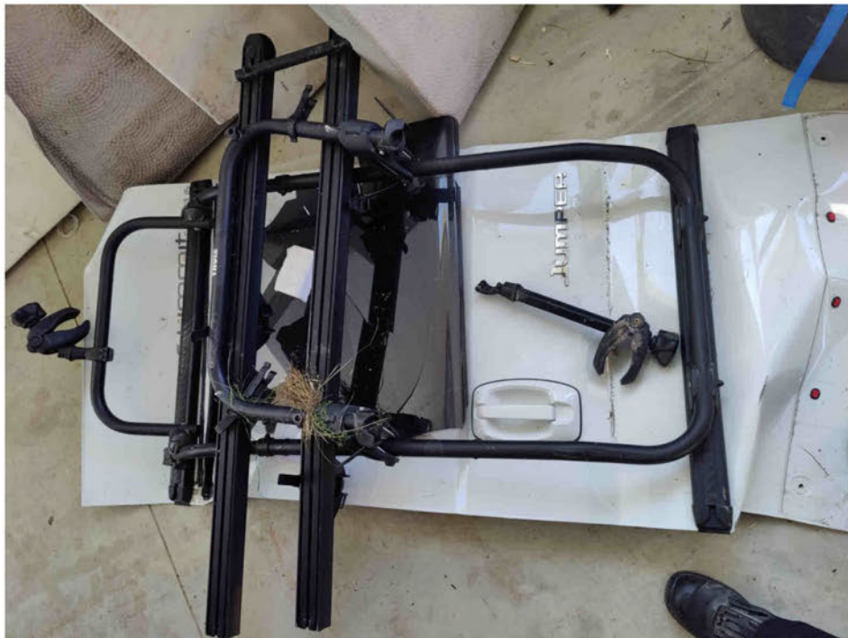
Bild 11 Radträger verformt, Türaußenhaut hinten abgelöst
